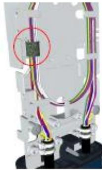
Placer une bande autocollante pour maintenir les μ-modules en place.
