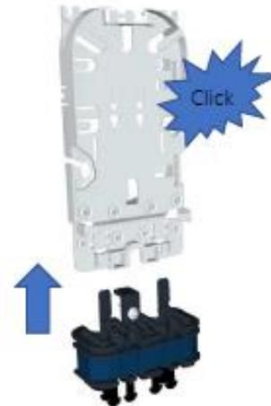
Positionner la base à gel sous la cassette principale. Pousser vers le haut jusqu'au 'Click' d'assemblage.
