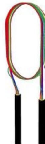
Faire une ouverture de 2 mètres dans le câble principal. Il est possible de stocker 10 mètres de  $\mu$ -modules de 6 ou 12 fibres.
