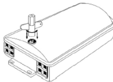
Pour ouvrir le boîtier utiliser la clé triangulaire en plastique prévue à cet effet.
