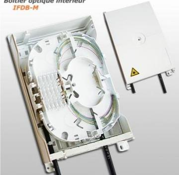
Le boîtier de palier **IFDB-M**, point de branchement en immeuble de vingt-quatre (24) épissures, a été conçu pour assurer le passage des câbles en colonne montante, et le piquage par raccord mécanique ou raccord fusion de douze (12) câbles abonnés (surcapacité comprise).
