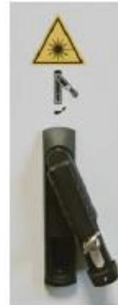
La porte esclave (porte gauche) s'ouvre à l'aide de 2 poignées de verrouillage pivotantes situées côté intérieur. Pour l'ouvrir, tirer les poignées situées en haut et en bas de la porte (voir photos ci-dessous).
