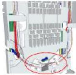
Placer les fibres dans les deux clips afin de garantir une parfaite position dans le boîtier
